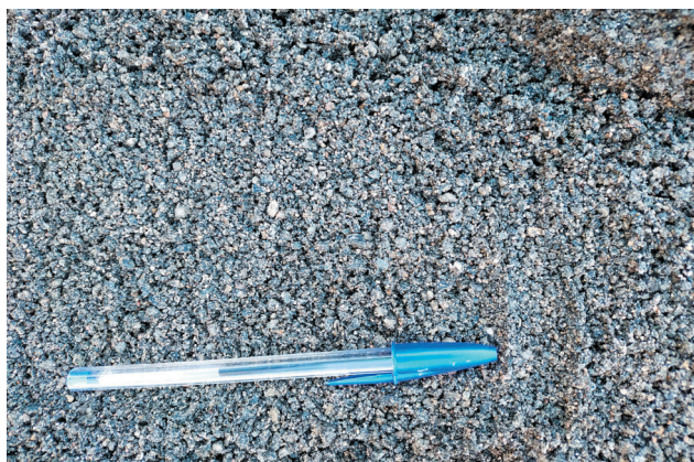
Árido fino 0/5 mm procedente de la trituración de roca caliza y conglomerado.
