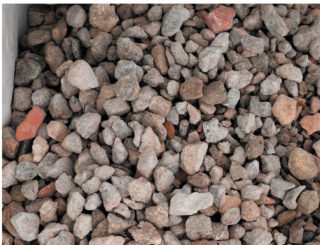
Árido grueso 5/12 mm reciclado de hormigón.
